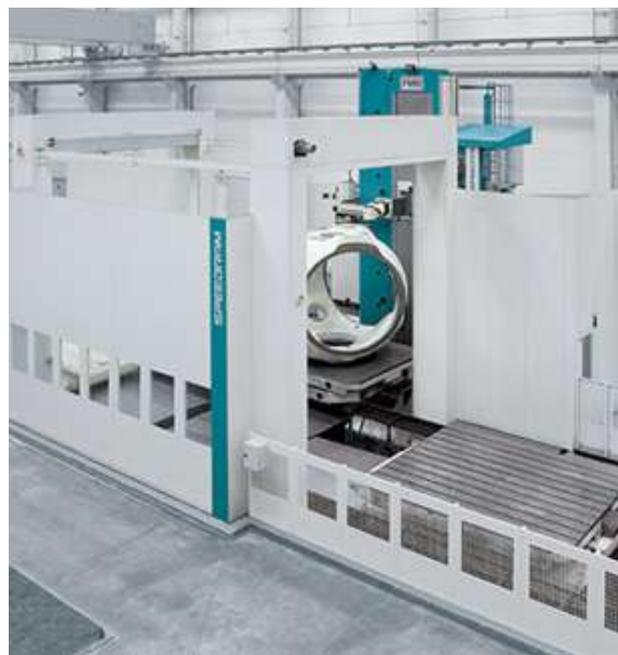
圖3 PAMA SPEEDRAM 4000鏜銑加工中心示意圖
